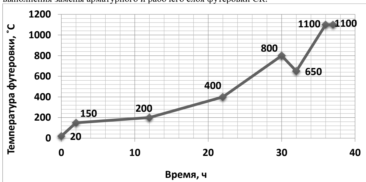
Рисунок 3 - Режим сушки и разогрева футеровки сталеразливочных ковшей после выполнения замены арматурного и рабочего слоя футеровки СК.
